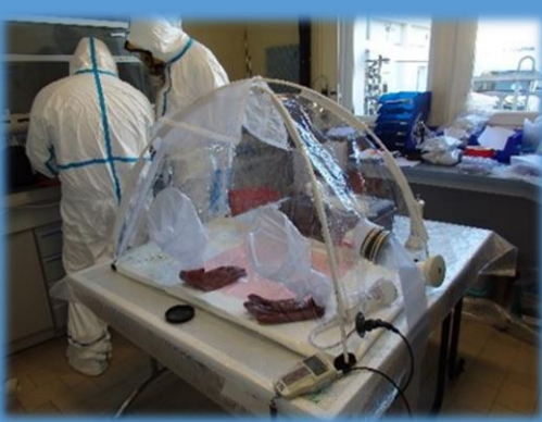
Formation à l'utilisation d'une boîte à gants jetable
