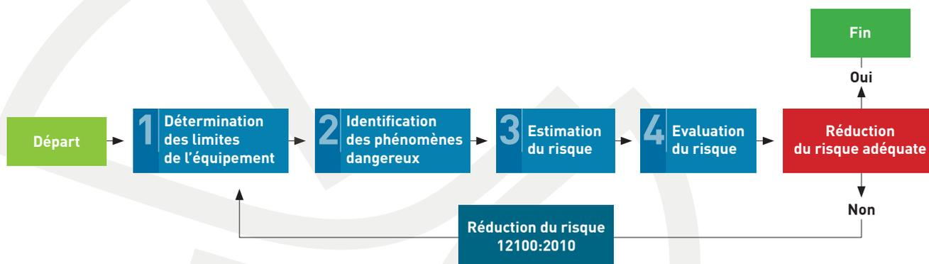
Fig. 9 : Méthodologie de l'évaluation du risque basée sur la norme EN ISO 12100:2010
