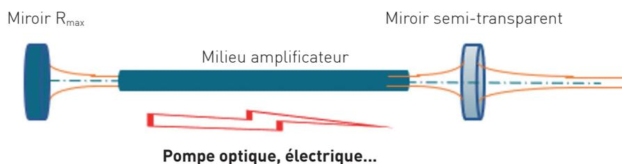
Fig. 3 : Schéma général d'un laser
