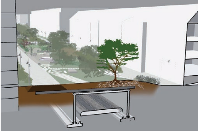
Principe de continuité des sols sur un jardin sur dalle.
