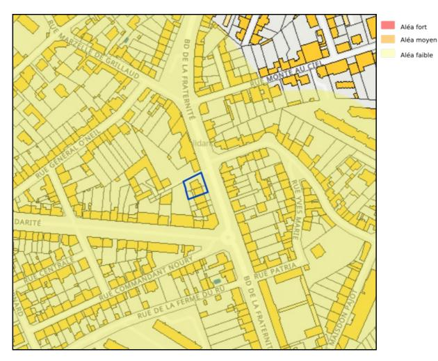
Figure 1 : Extrait cartographique du zonage réglementaire de l'aléa « retrait-gonflement des argiles » (source : BRGM, Etalab)
