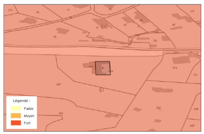
**CARTOGRAPHIE DES MOUVEMENTS DE TERRAINS (ARGILES) - EI453**
