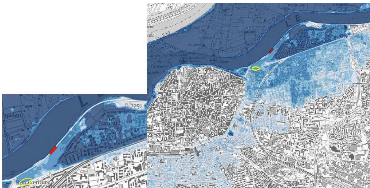
Localisation de la brèche potentielle dans la digue de Bonaventure (en jaune)
