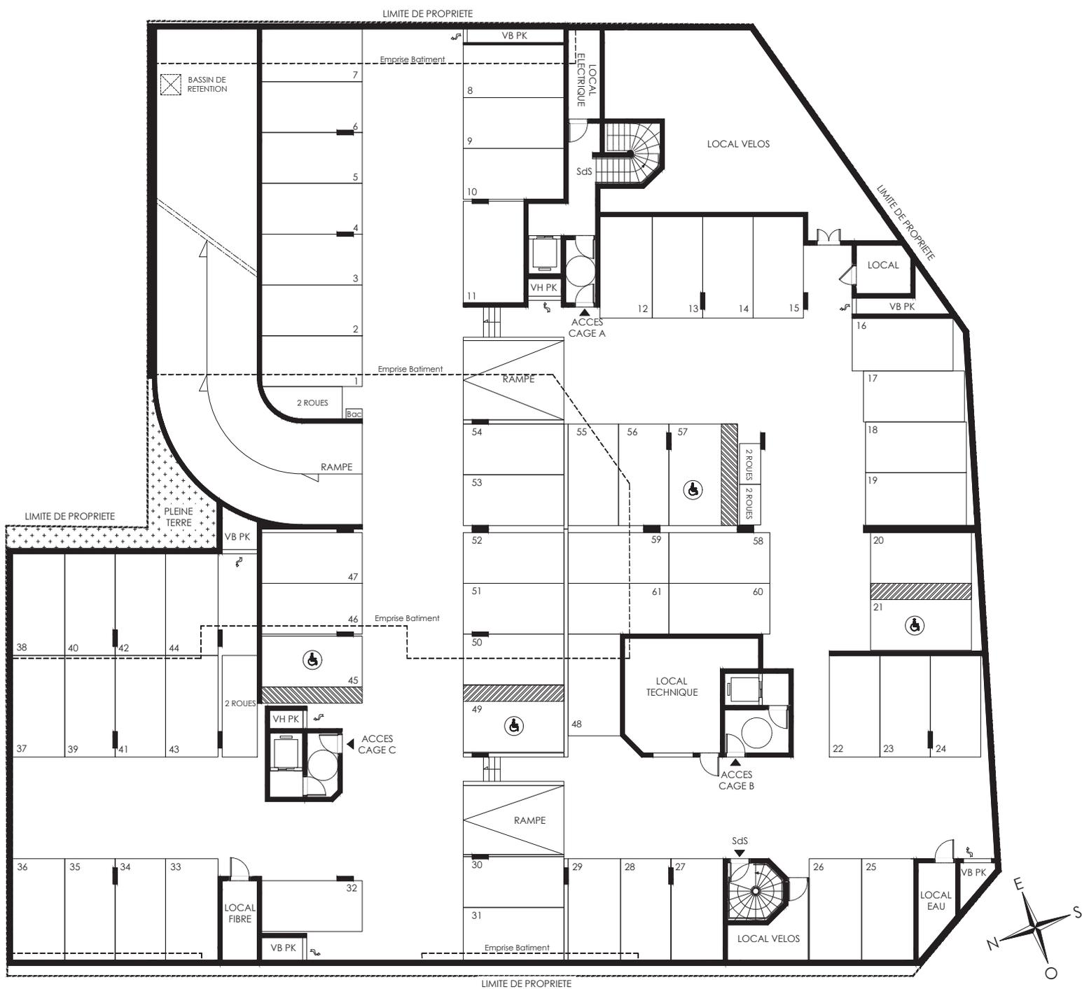
LEGENDE : SdS : Sortie de secours / VH : Ventilation haute / VB : Ventilation Bas / Bac : Bac à sable / Place Handicapé
