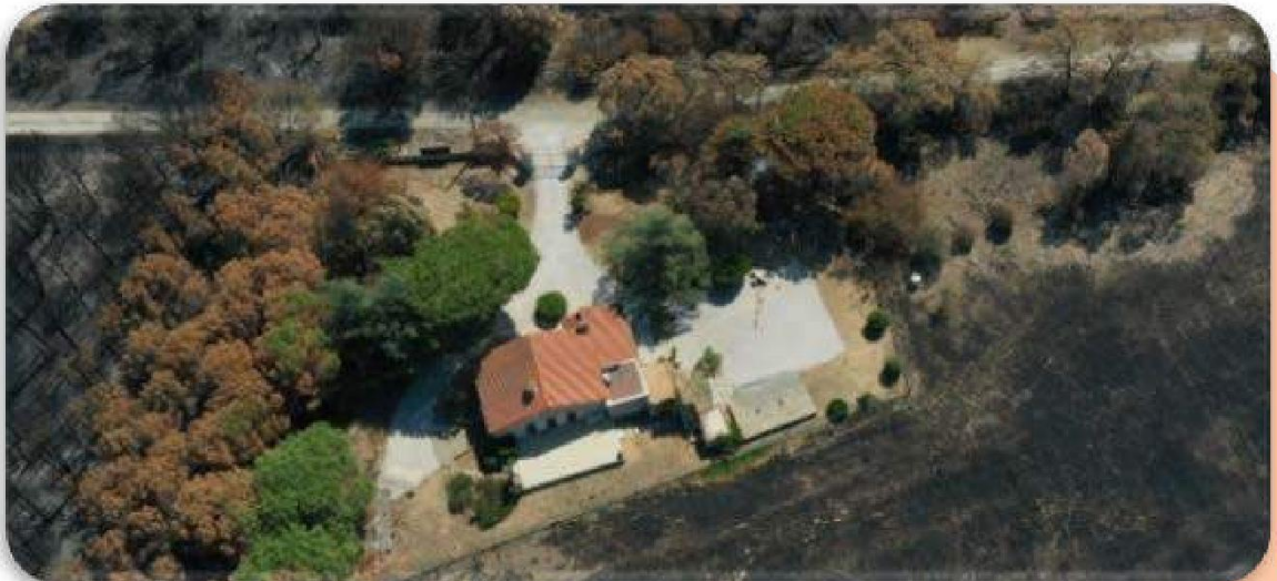
Maison débroussaillée épargnée par le passage d'un feu - source : ONF, retravaillée
