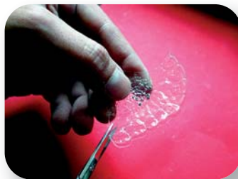
La première plaque en 0,5 mm est découpée avec des ciseaux...
