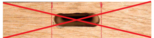
Mortaise incorrecte : l'assemblage sera impossible.
