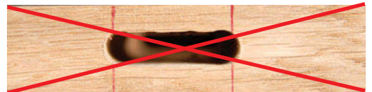
Mortaise incorrecte : l'assemblage sera trop lâche.
