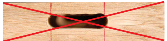
Mortaise incorrecte : l'assemblage sera trop lâche.
