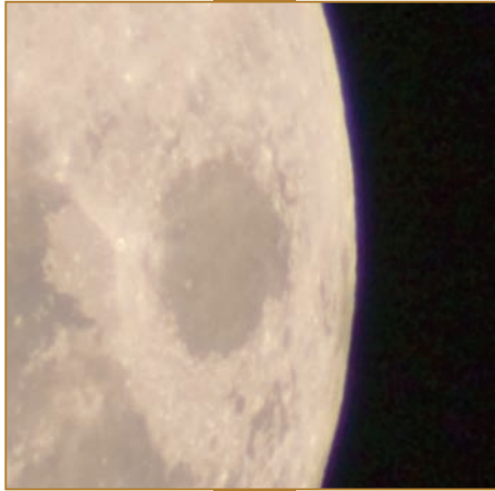
Portion d'une image de Lune prise avec un appareil numérique sur une lunette achromatique. Le liseré pourpre entourant le limbe est dû à l'aberration chromatique de la lunette.
