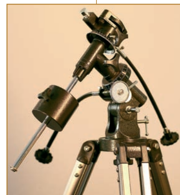
Une monture équatoriale motorisable. En l'absence de moteur, à cause des vibrations et des irrégularités produites, les mouvements manuels peuvent seulement être employés pour recentrer la planète et non pour assurer son suivi continu.
