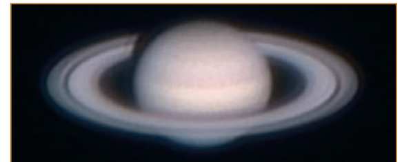
Images de Saturne traitées de manière classique (compositage et masque flou), obtenues avec une lunette apochromatique de 150 mm de diamètre et une webcam. Des disques en papier placés à l'avant de l'instrument simulent diverses obstructions, respectivement 0 %, 20 %, 35 % et 50 % (de haut en bas).
