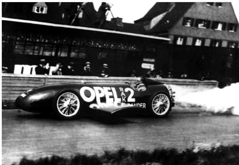
■ L'Allemand von Opel construisit des voitures, avions, et trains propulsés à l'aide de fusées. Grâce à eux, il dépassa les 200 km/h !
