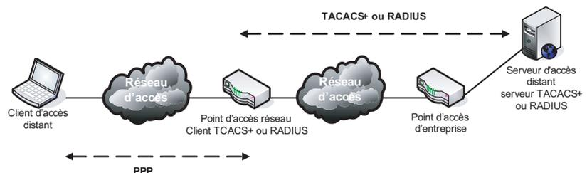
Dans ce type d'accès très répandu, les éléments de chiffrement réalisés par les protocoles TACACS+ et RADIUS sur les informations échangées ne s'appliquent que sur une partie du trafic entre le client et le serveur TACACS+/RADIUS.
