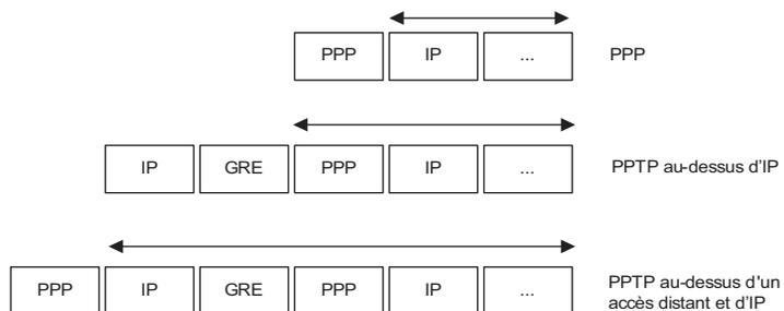
MPPE (Microsoft Point-to-Point Encryption) crypte les données des connexions d'accès distants PPP ou des connexions VPN PPTP. Les méthodes de chiffrement MPPE utilisent des clés de longueur variable, de 40 à 128 bits. Ces méthodes sont prises en charge par le chiffrement des données (RC4). MPPE assure la sécurité des données entre la connexion du client distant (connexion PPTP) et le serveur d'accès distant.
