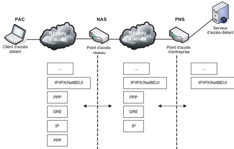
PPTP utilise en parallèle une connexion de contrôle entre le couple PAC-PNS via une session TCP sur le port 1723, de façon à transmettre les informations de contrôle et de gestion des appels PPTP, ainsi qu'un tunnel IP entre le couple PAC-PNS pour le transport des paquets PPP encapsulés par GRE (service numéro 47).
