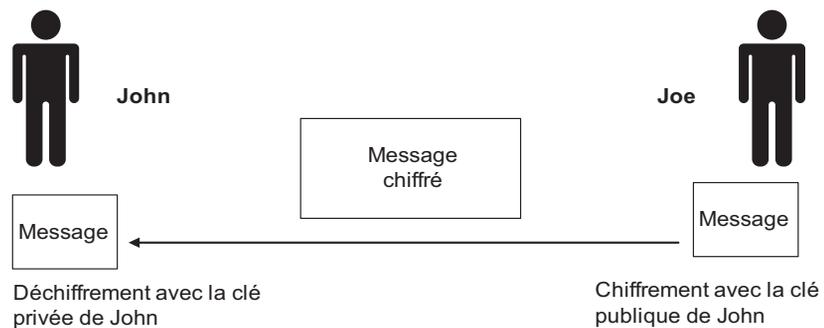
Les algorithmes de chiffrement asymétrique ne font jamais transiter les clés privées sur le réseau. La sécurité de tels algorithmes tient au fait que la clé privée n'est pas divulguée et que, même avec les clés publiques, il est très difficile dans un temps raisonnable de calculer les clés privées à partir des clés publiques.
