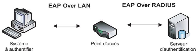
Les messages EAP peuvent être de quatre types : requêtes, réponses, succès et échec. La figure 8.13 illustre une authentification réussie.
