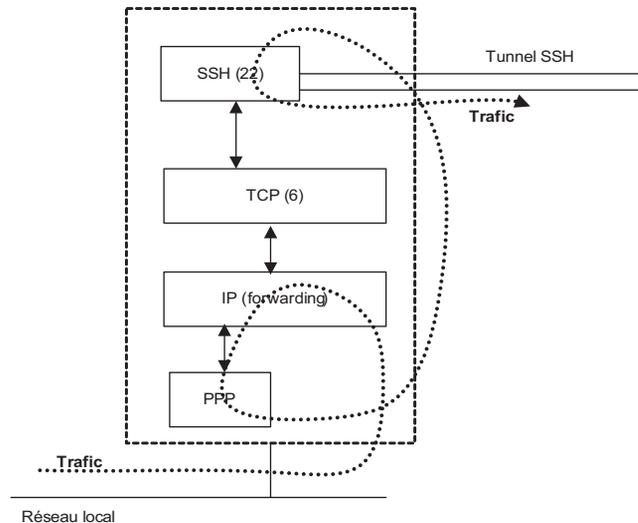
L'autre extrémité réalise le cheminement inverse pour retrouver les paquets IP initiaux. L'option permettant de relayer les paquets au niveau de la pile protocolaire IP des systèmes concernés doit être activée.
