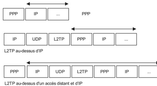
Pour établir une session L2TP, le client se connecte à distance *via* le protocole PPP à un concentrateur d'accès L2TP, ou LAC (L2TP Access Concentrator), de son FAI. Ce dernier établit un tunnel vers le serveur réseau L2TP, ou LNS (L2TP Network Server), qui est généralement réalisé par un routeur. Il est aussi possible que la fonction de LAC soit directement réalisée par l'ordinateur client, comme nous le verrons par la suite.
