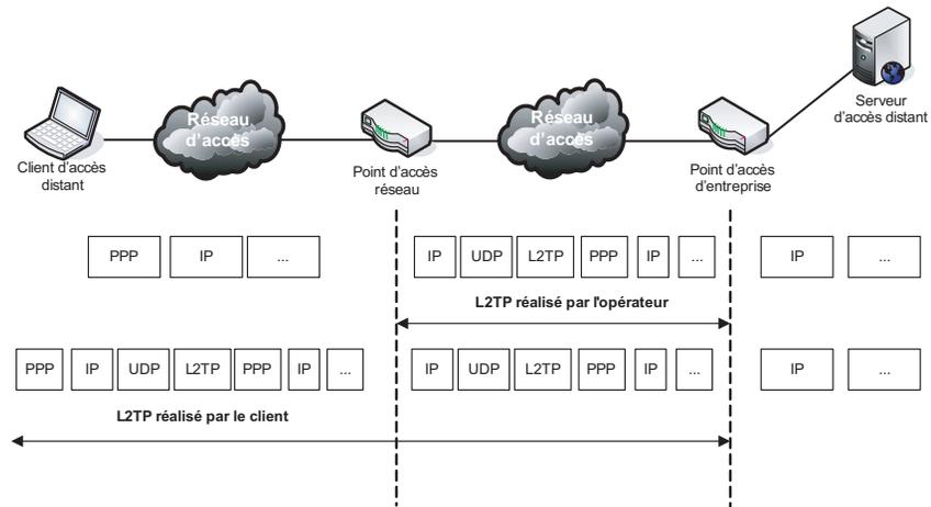
L2TP utilise en parallèle, sur un tunnel donné entre le couple LAC-PNS, les messages de contrôle, de façon à gérer les sessions, ainsi que les paquets PPP encapsulés par L2TP et reposant sur UDP (port 1701). Dans le cas où le client gère la fonction L2TP, il doit gérer deux sessions PPP, l'une avec le point d'accès réseau et l'autre avec le point d'accès.
