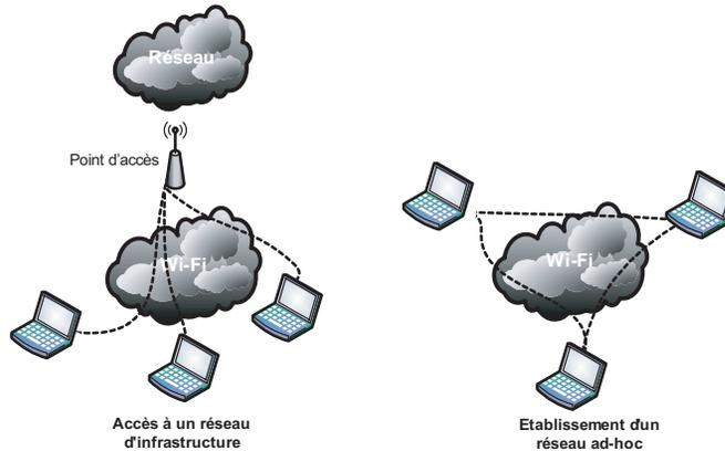
Côté sécurité, la norme 802.11 a défini le protocole WEP (Wired Equivalent Privacy) afin d'assurer la confidentialité et l'intégrité des données. De plus, elle a défini deux mécanismes pour gérer le contrôle d'accès et l'authentification du poste utilisateur (aucune authentification, authentification fondée sur un secret partagé).
