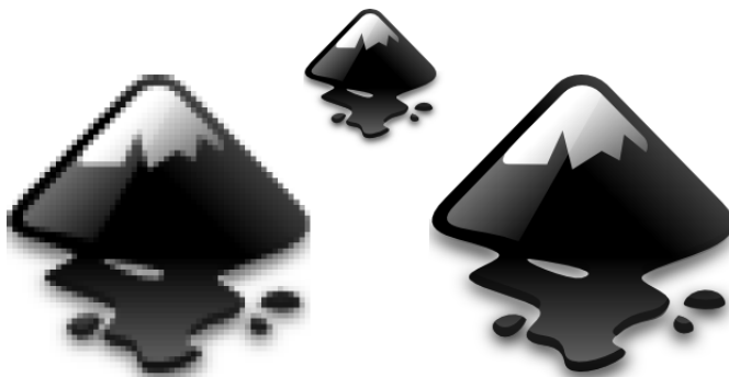
FIGURE 0-1 Zoom comparé d'une image matricielle (à gauche) et d'une image vectorielle (à droite)
