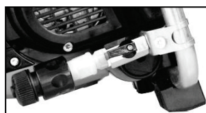
Alimentation d'eau ouverte (levier de vanne parallèle)
