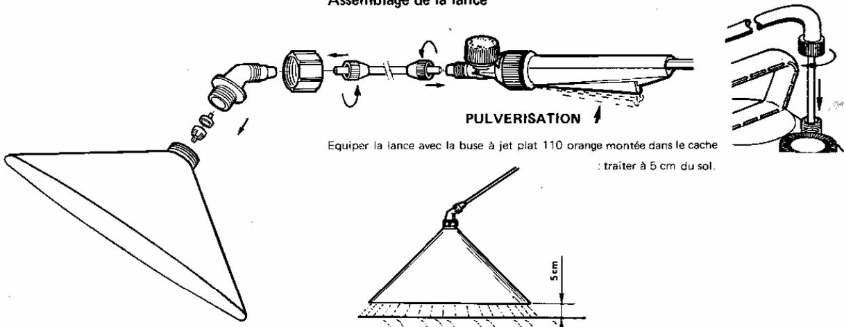
Equiper la lance avec la buse à jet plat 110 orange montée dans le cache
