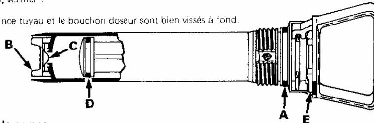
**B - Graissage des joints de pompe :**
