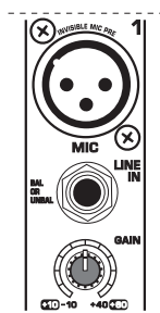
Fig. 2.1: Connecteurs et potentiomètre des entrées micro/ligne
