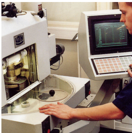
Figure 26.3 GAUCHE : Machine avec outil diamanté ; DROITE : Polissage de lentilles
