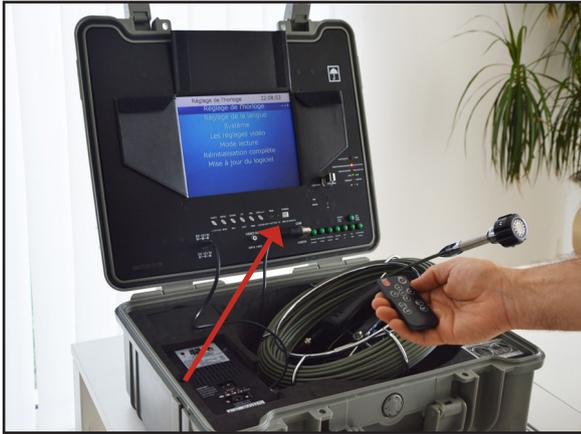
1. Appuyez sur le bouton «**Mise en marche**» situé sous l'écran à droite ou sur la télécommande pour allumer l'écran.
