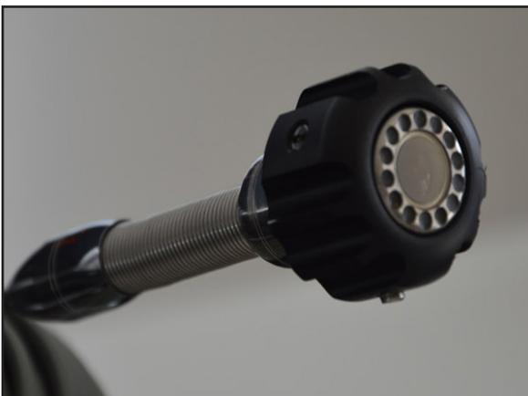
3. Insérez le centreur sur votre tête de caméra et serrez les vis, afin de bien le maintenir sur la tête, et de ne pas perdre l'accessoire dans la canalisation.
