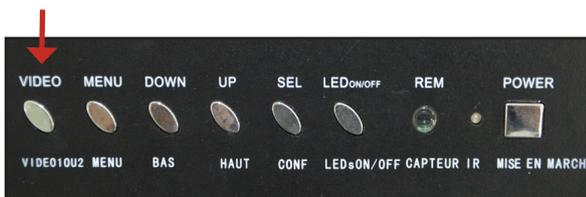
**Vidéo** : passer du mode AV1 à AV2 / **Menu** : régler la luminosité, les contrastes et couleurs / **Bas et Haut** : baisser ou augmenter (dans le menu) / **Conf** : sélectionner / **LED on/off** : allumer ou éteindre les LEDs / **Mise en marche** : allumer ou éteindre l'écran
